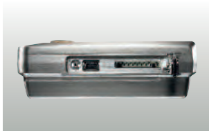
Разъем для подключения Мини-USB кабеля или SD-карты
